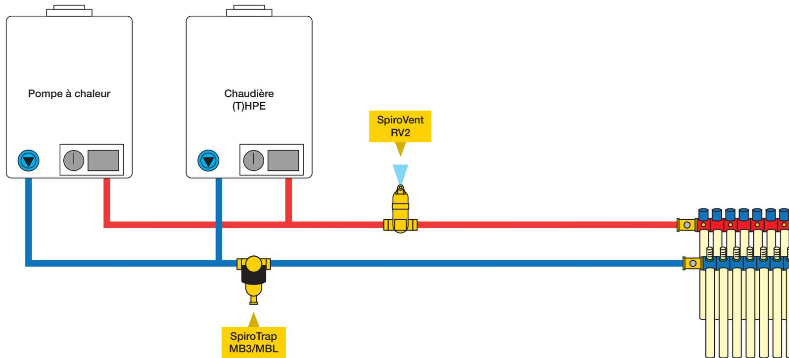
Schéma : circuit PAC hybride avec SpiroVent RV2 et SpiroTrap MB3/MBL
