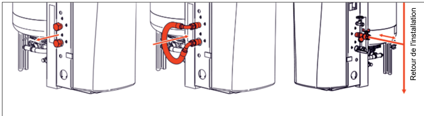
Figure 14: Connexion des raccords au kit Bypass et raccordement au retour du système
